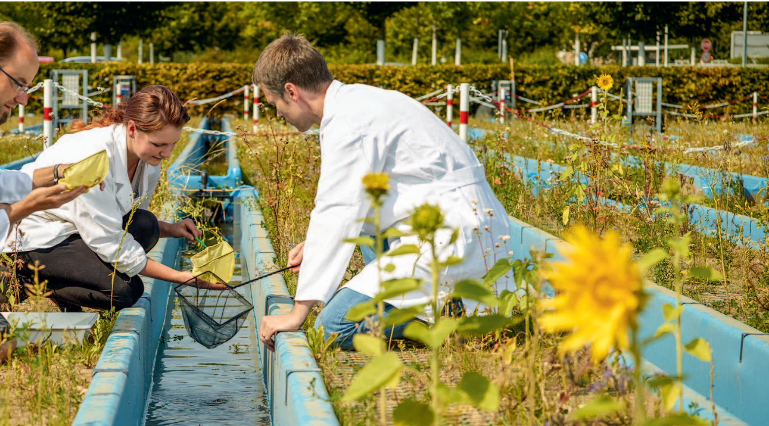
...ss realitätsnah werden. So lautet eine Forderung der Leipziger Wissenschaftler. Entscheidende Erkenntnisse erhoffen sie sich von einem der weltweit größten Fluss-Experimente. In 47 jeweils 14 Meter langen künstlichen Fließbrinnen testen die Forscher dort die Reaktionen von Wasserlebewesen auf Pestizide unter deutlich realeren Bedingungen
